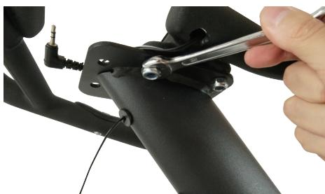
\*緩み防止のため樹脂ナットを採用しています。樹脂の見える青い部分を床側にし、⑫スパナで締め樹脂を貫通させてください。
