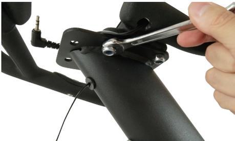
\*緩み防止のため樹脂ナットを採用しています。樹脂の見える青い部分を床側にし、⑦スパナで締め樹脂を貫通させてください。
