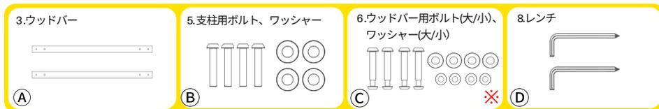
※ Ⓒ ウッドバー用ボルトは、(大)と(小)が接続された状態でお届けします。計4組、合計8本のボルトが同梱されていることをご確認ください。組立てを始める前に、あらかじめボルト(大)と(小)を外してください。
