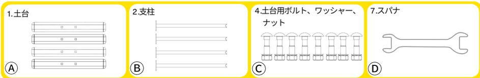
①土台と②支柱の取り付け穴を合わせます。下側から③土台用ボルトを挿し込み、上側から③土台用ワッシャー、土台用ナットの順に接続します。④スパナ(17mm)を使用し、③土台用ナットを回して仮留めします。同様に4本分を組立てます。
