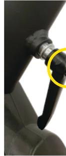
㉑ハンドルチューブの高さ調整穴と㉕高さ調整ノブが噛み合っていない場合、ノブ内部のバネが浮き出てしまいます。穴同士が噛み合うことで解消されますので高さの調整を行ってください。
